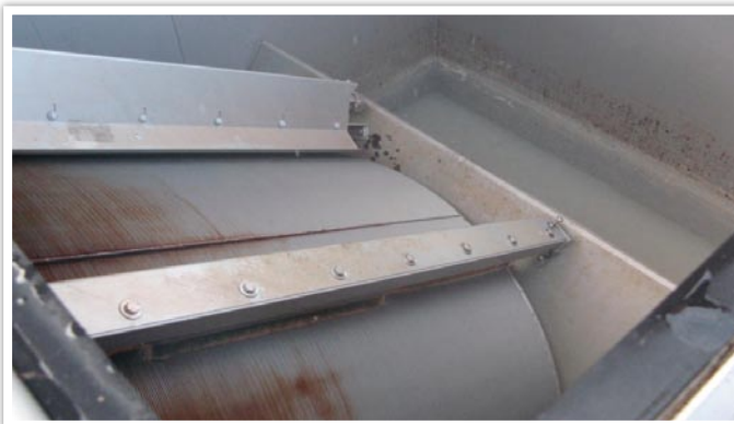
Abb. 1: Siebanlage – geeignet sind Lochungen von 2 – 3 mm
